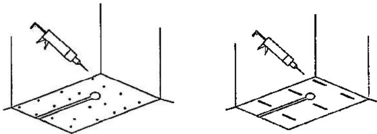
6. Traiter les points singuliers: Les raccords sol/mur doivent être étanches et traiter à la périphérie à l'aide d'une **bande d'étanchéité** adaptée à la pose sur ouvrage flottant (c'est-à-dire de « légers mouvements »).
