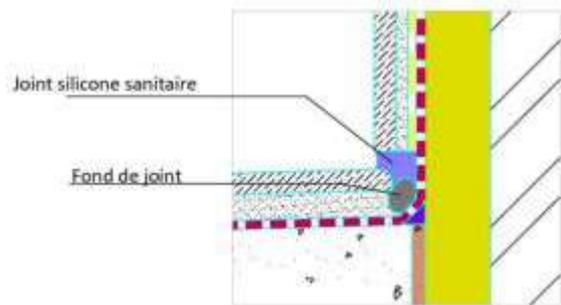
L'étanchéité doit être assurée avec un **joint souple** (n°1) à l'alcool traité fongicide sur un **fond de joint en mousse**. Le **joint de finition** (n°2) devra être traité fongicide et sera posé après la pose du carrelage.
