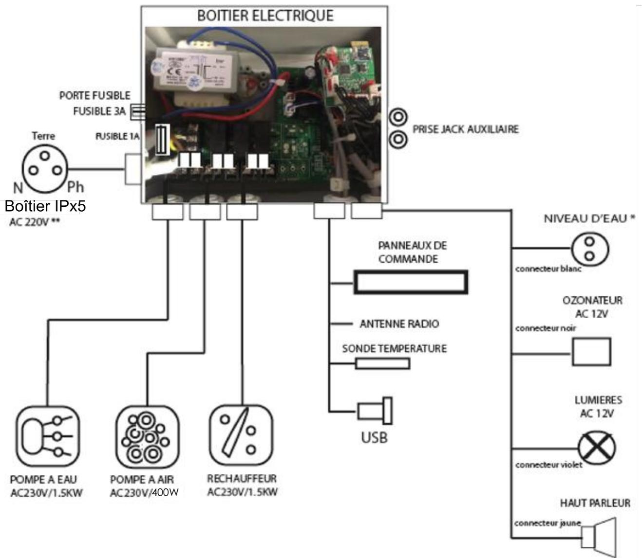
\* Remplir 2 cm au-dessus des détecteurs de niveau d'eau
